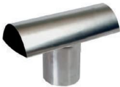
É composto por uma aba e um gargalo em alumínio polido. Utilizado em fachadas como terminal da chaminé, impede o retorno dos gases queimados. Comprimento do gargalo: 15 a 30cm. Possui modelos para encaixe interno ou externo.
