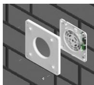
Com o auxílio de uma chave Philips fixe o aparelho na parede ou forro utilizando os 04 parafusos  $\varnothing 3,5 \times 50\text{mm}$ .
